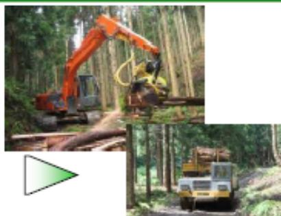
高性能林業機械による伐採収集運搬
